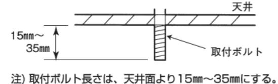
(注) 取付ボルト長さは、天井面より15mm~35mmにする。
